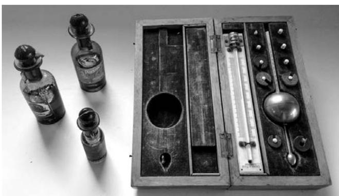
**Densimetro.** Era in dotazione di alcune farmacie ottocentesche specializzate nel ricavare i medicamenti e nel rilevarne le caratteristiche chimico-fisiche
