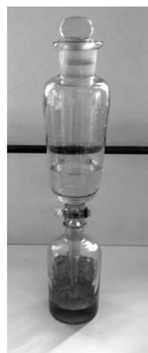
**Percolatore.** Era uno strumento semplice e rudimentale che serviva per la preparazione delle tinture e degli estratti. La droga frantumata e ridotta in polvere veniva introdotta all'interno del percolatore, dopo di che si versava il solvente alcoolico che per lenta infusione e imbibizione scendeva per gravità raccogliendo i principi attivi della droga. In un recipiente sottostante il percolatore veniva raccolto l'estratto
