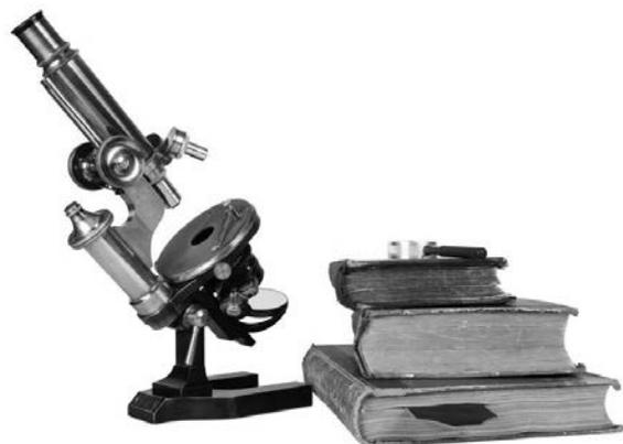
**Microscopio.** Strumento fondamentale per il farmacista ottocentesco. Serviva al riconoscimento delle droghe e delle spezie e all'individuazione delle sofisticazioni
